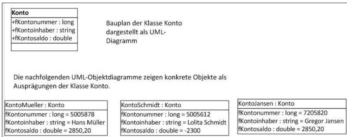
Abbildung 1-2 UML-Klassen- und Objektdiagramme mit Datentypen
